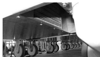
Нижняя сторона устройства. На нижней стороне находится входное воздушное отверстие.
