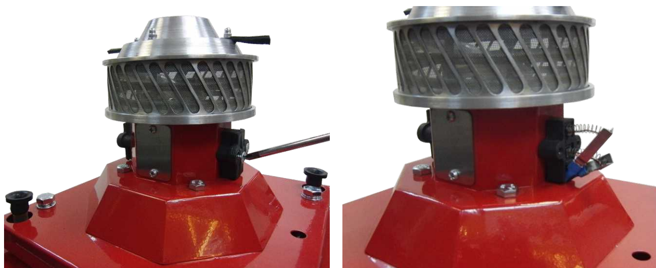
Рис.8. Замена щеточного узла
